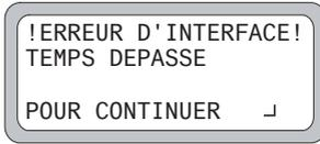
Le signal indiquant que la barre de levage a été levée ou abaissée n'a pas été retourné dans les 500 ms qui ont suivi le démarrage de l'opération.
